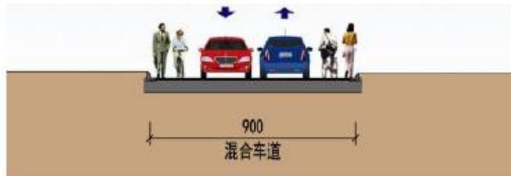
图 2.3-3 开创路北延（皮岔河～盐兴路段）现状道路标准横断面图
