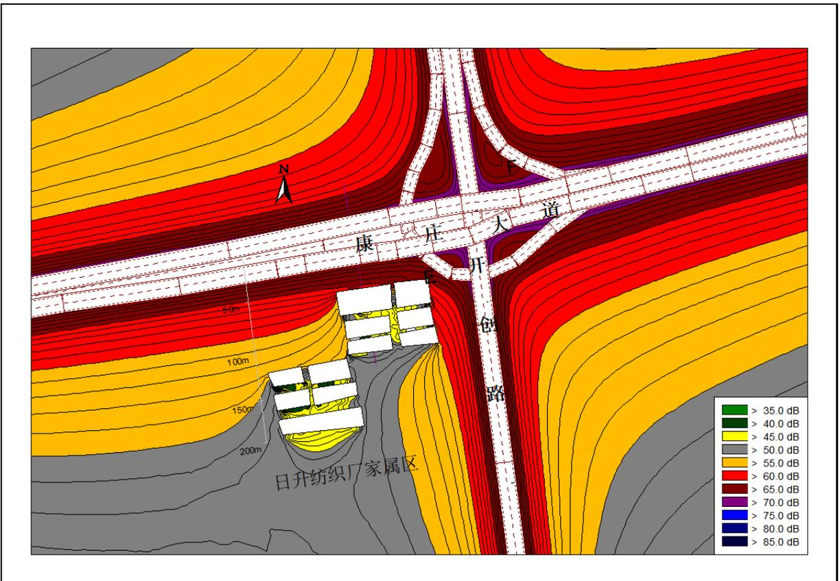
图 4.2-7 沿线典型敏感建筑水平向声场等声级线图
