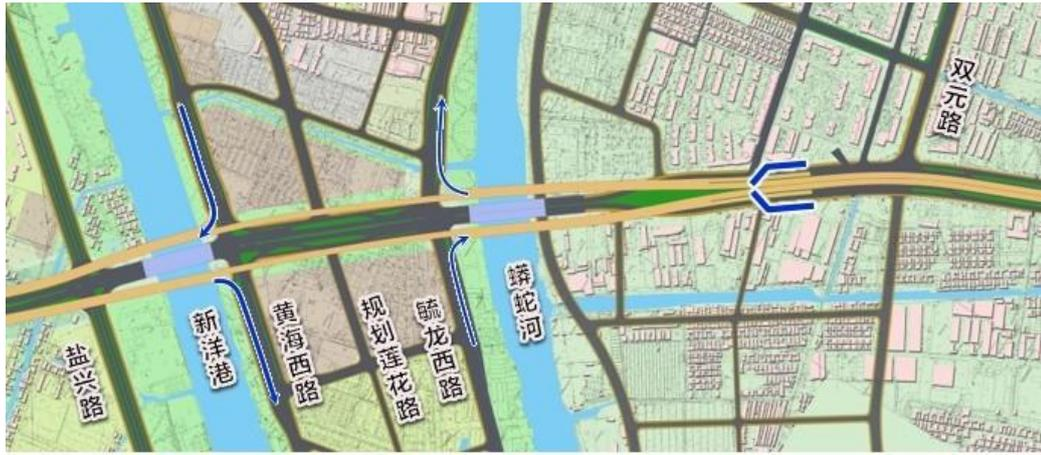
西环路高架北延节点控制方案示意图
